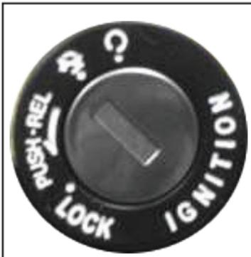
Chapa de encendido de columna de dirección:
